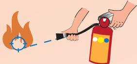
【壓】壓下壓把。【掃】左右掃射火源根部。
