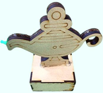
運用IC、電晶體、電阻、電容等作出一個觸控電路，將原本需要寫程式運用到微控制器的作品透過這些電子材料就能達成，在學習的過程中了解到這些電子零件的基本概念，產生出來的效果搭配上神燈的造型讓人產生出奇幻的感覺。
